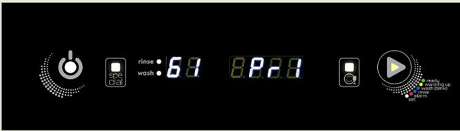
Die ProTouch-Steuerung kombiniert intuitive Bedienung mit innovativer Technologie und macht den Spülprozess effizienter und komfortabler. Mit bis zu 15 wählbaren Programmen bietet sie eine hohe Flexibilität für unterschiedliche Anforderungen. Zwei große LED-Displays mit weiß hinterlegten Segmentanzeigen sorgen für eine klare Darstellung von Temperaturen und Dialogmeldungen.
